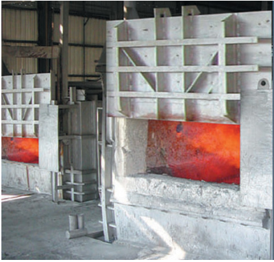
El horno de fundición, vaciado y formado de lingotes cilíndricos para extrusión.
