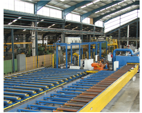
Modernas prensas de extrusión de aluminio operadas automáticamente con pullers robotizados.
