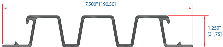
PERFIL P/PISO REFRIGERADOR 9806
