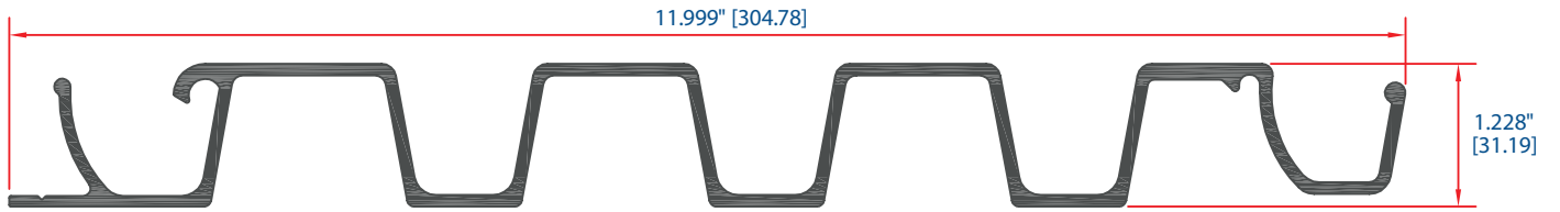
PERFIL P/PISO REFRIGERADOR 9805
